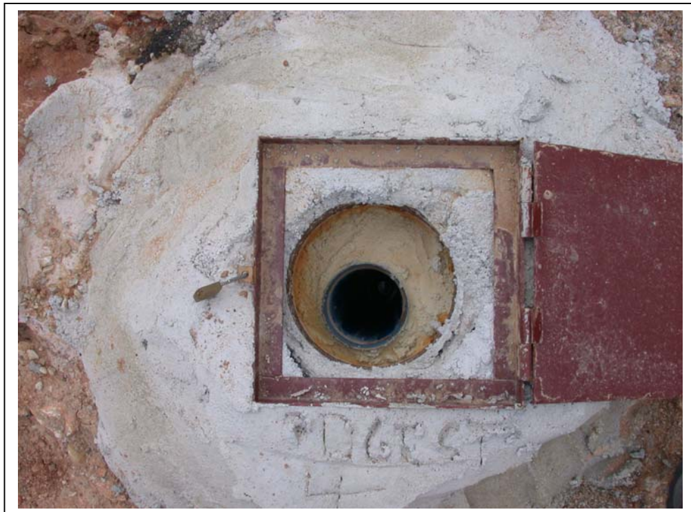
Detalle del estado final del sondeo
