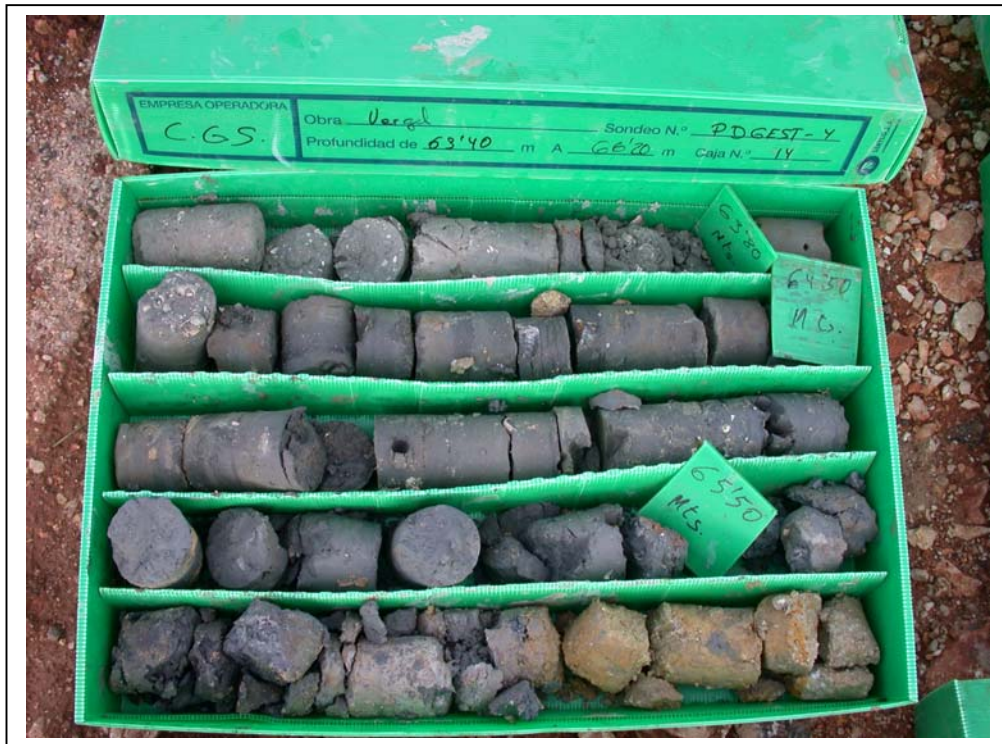
Detalle de una de las cajas de testigos
